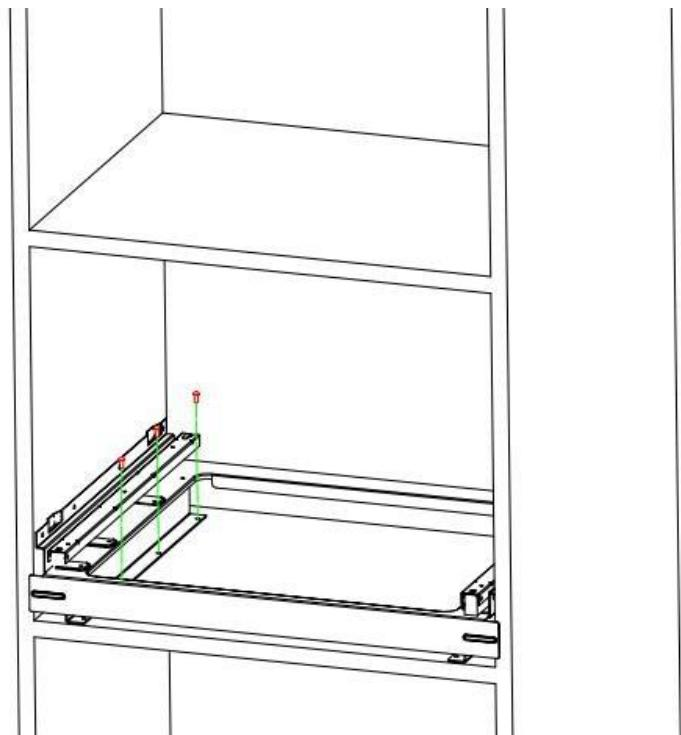
Шаг 2: при монтаже к нижней планке (когда под кофемашиной не располагается никакая другая техника) закрепите соединительный кронштейн винтами.
