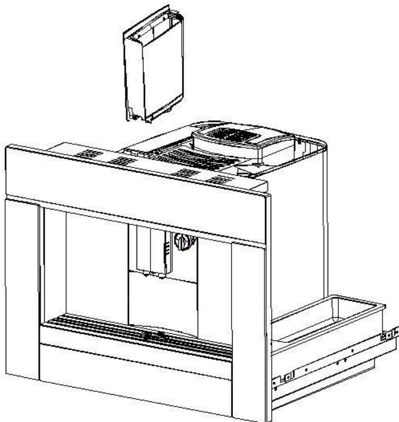
Шаг 7: извлеките резервуар и добавьте в него чистую воду, затем установите его в исходное положение, установите машину в шкаф, вставьте вилку в розетку и включите главный переключатель (A5).
