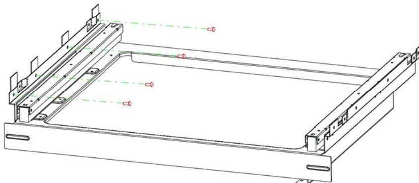
Шаг 1: при боковом методе монтажа (когда кофемашина устанавливается над ящиком для подогрева или другой техникой) установите направляющий соединительный кронштейн и закрепите его винтами.
